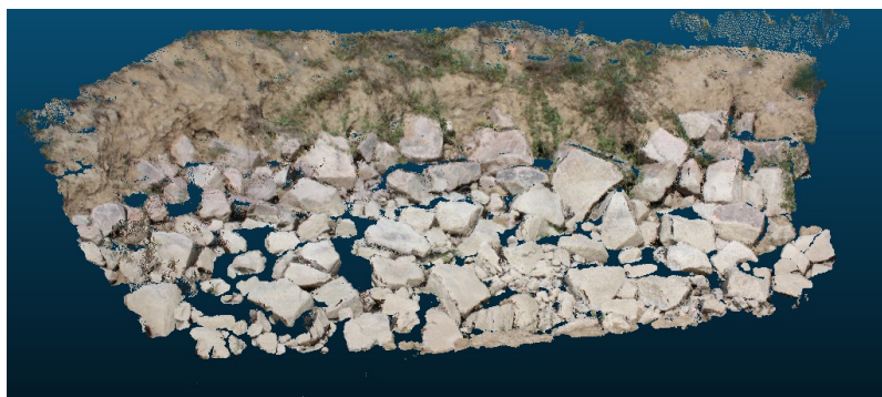
Illustration 14 : Photogrammétrie de la fraction d'enrochement suivie (état initial) – Cerema – 17/10/16
