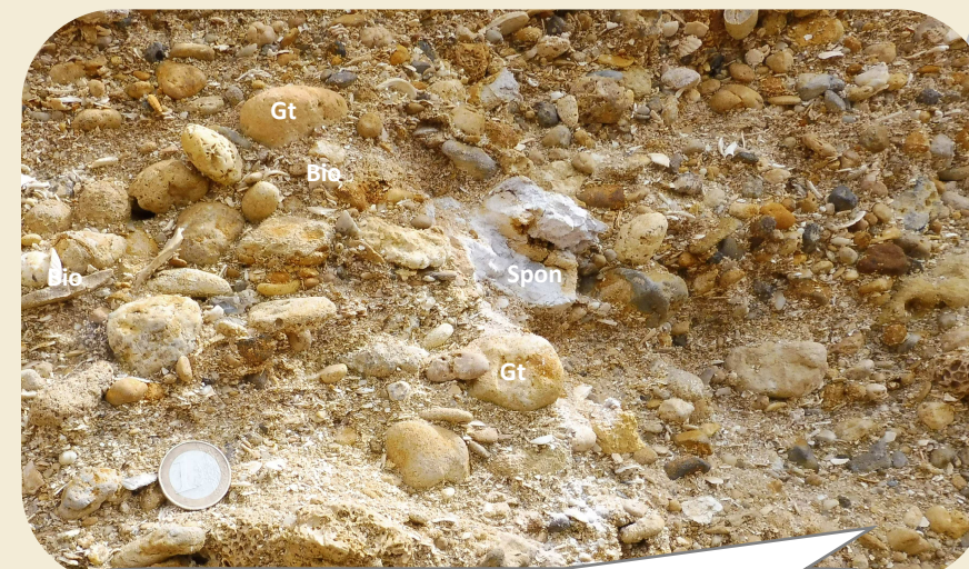
Fig.5 : Aspect du falun sain. La taille des éléments le constituant varie du millimètre au centimètre et présente une grande diversité : bioclaste (Bio), galet (Gt), spongolithe (Spon). L'échelle est donnée par la pièce.
