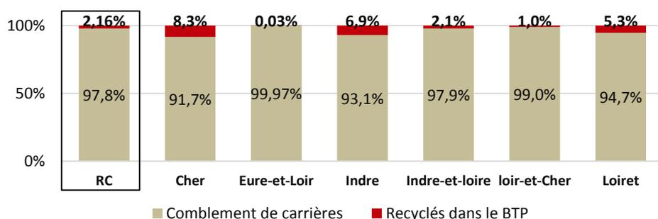
Outre l'utilisation en comblement des carrières, les déchets inertes du BTP peuvent être recyclés en tant que matériaux pour un usage destiné aux travaux publics.
