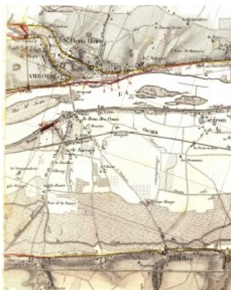
Extrait de carte de 1850 surchargée des emprises de crues historiques (en rouge, celle de 1866) En rive droite, la localisation de la brèche est figurée (NB : le nord est en bas de la carte)
