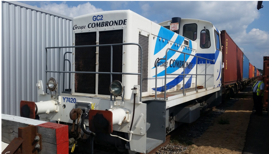
Illustration 3 : L'un des locotracteurs du Groupe Combronde, ici à Vierzon, permettant de réaliser les manœuvres ferroviaires sur les terminaux de manutention rail-route.
