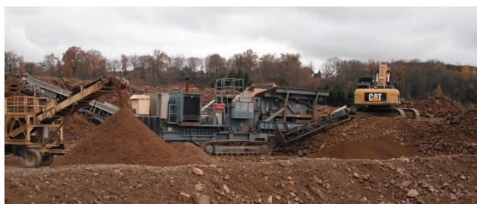
*Exemple de concasseur mobile actionné par un groupe électrogène à Bonneuil (36)
