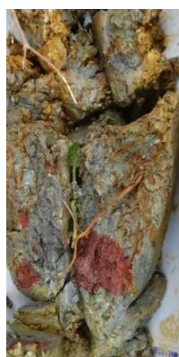
Horizon réductique mis en évidence par l'orthophénanthroline
