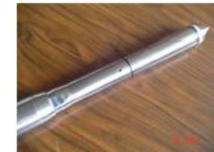
Photo 2 : pointe de penetrometre statique
