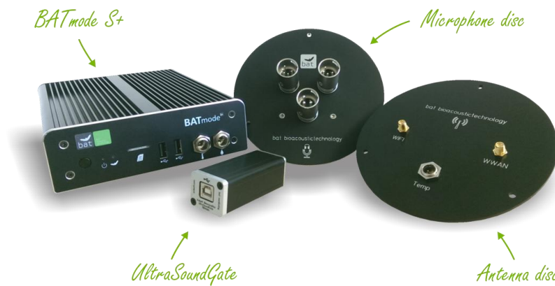
Figure 8 : Dispositif installé dans la nacelle d'éolienne (copyright : B.A.T.)
