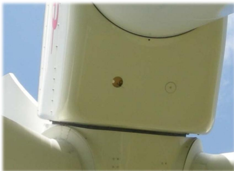
Photo 15 : Position du micro de l'Anabat SD1 dans l'étude néerlandaise (LIMPENS et al. , 2013)
