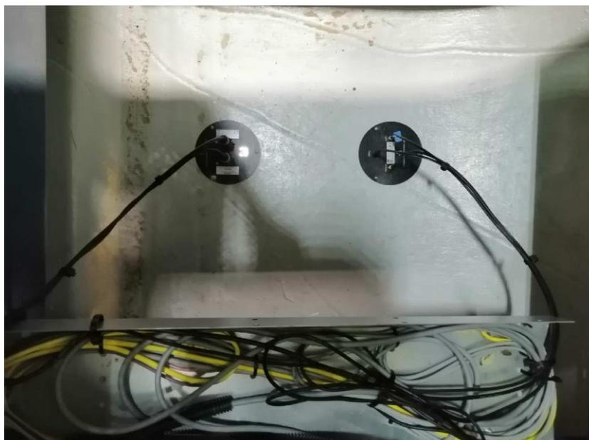
Figure 3 : Disque micro (premier plan), disque antenne et sonde (deuxième plan)
