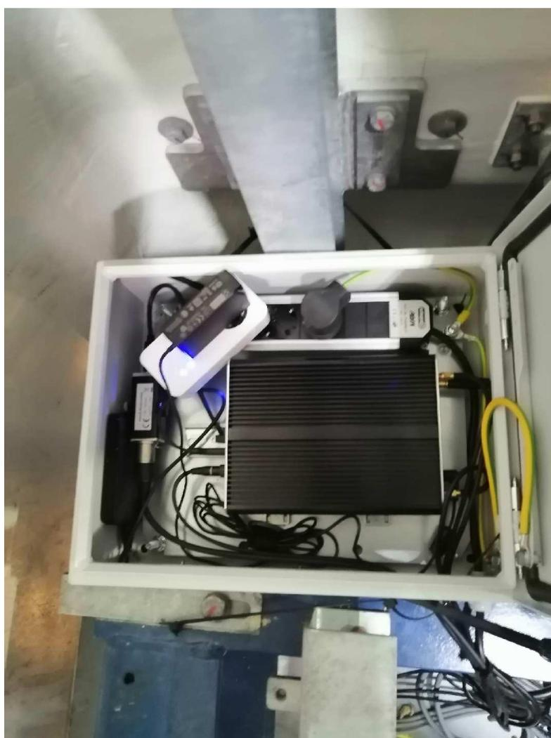
Figure 4 : BATmode et système d'alimentation à l'intérieur de la BATbox
