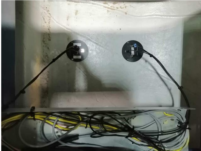
Figure 8 : Disque micro (premier plan), disque antenne et sonde (deuxième plan)
