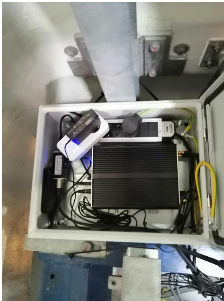
Figure 9 : BATmode et système d'alimentation à l'intérieur de la BATbox
