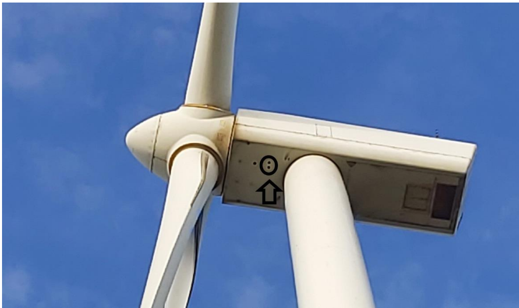
Figure 2 : exemple d'installation d'un BATmode en nacelle
