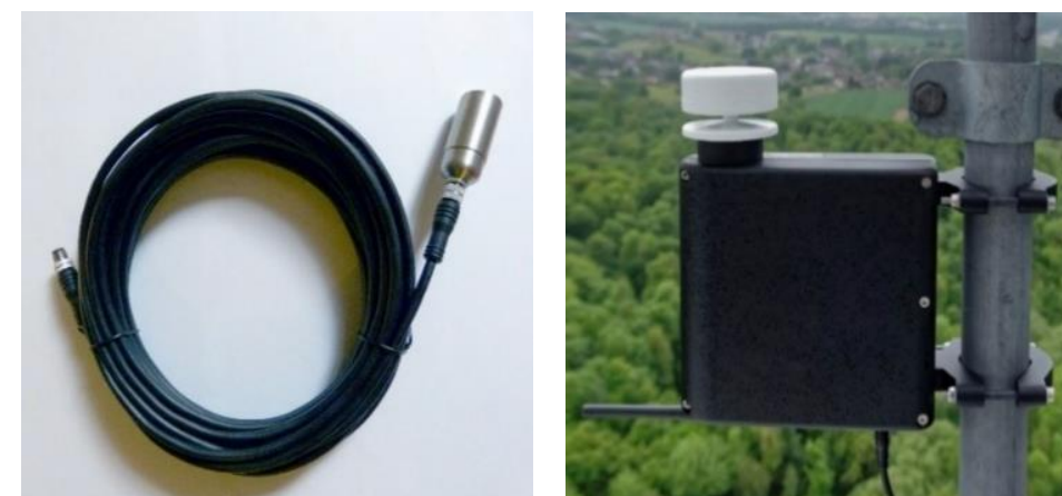
Figure 17 : Microphone mobilisé pour les études en altitude (à gauche) et boîtier TrackBat avec microphones intégrés, installé sur la nacelle d'une éolienne (à droite).
