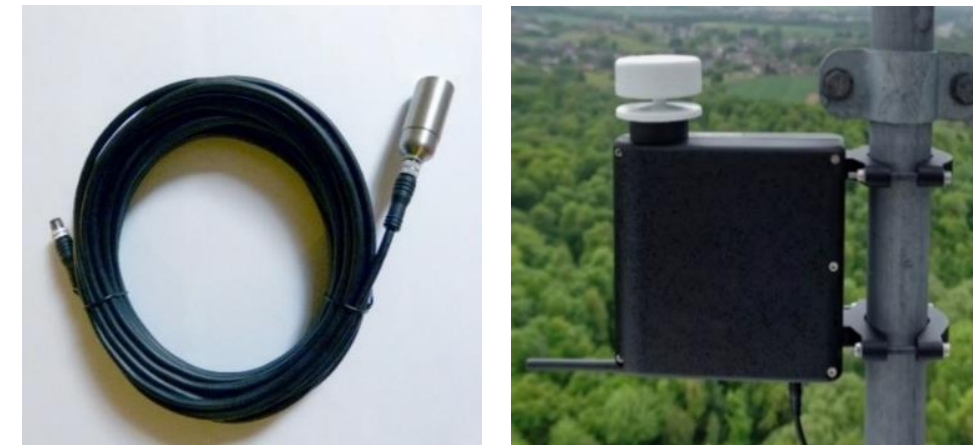
Figure 14 : Microphone mobilisé pour les études en altitude (à gauche) et boîtier TrackBat avec microphones intégrés, installé sur la nacelle d'une éolienne (à droite).
