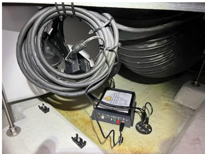
Batlogger installé dans la nacelle de l'éolienne E6 Source : GTH2air (Photographie prise sur site).
