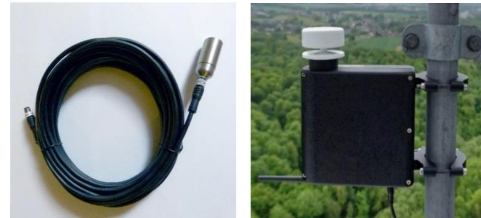
Figure 12 : Microphone mobilisé pour les études en altitude (à gauche) et boîtier TrackBat avec microphones intégrés, installé sur la nacelle d'une éolienne (à droite).
