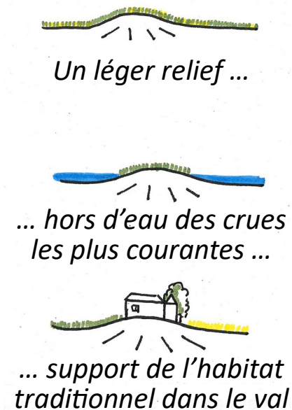
Schéma de principe d'un montil (I. Soller)
