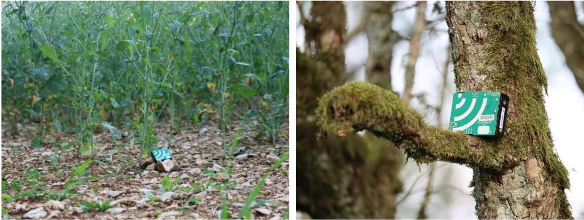
Installation du dispositif d'écoute en continu (Audiomoth) (photographies prises hors site)
