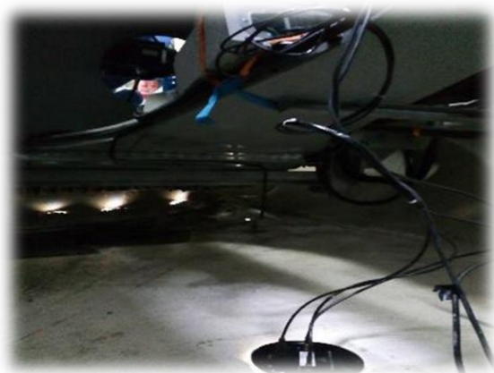
Exemple de Batmode S+ installé en nacelle (Écosphère)
