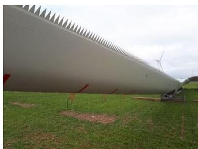
Photo 13 – Serrations sur le bord de fuite d'une pale (N. Flamand - Ecosphère)
