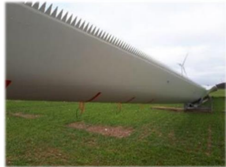
Serrations sur le bord de fuite d'une pale (N. Flamand - Ecosphère)
