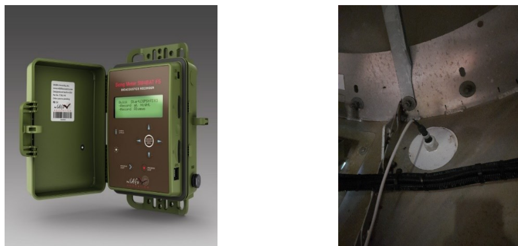
Figure 2 Illustrations d'un SM4BAT et de la protection du microphone
