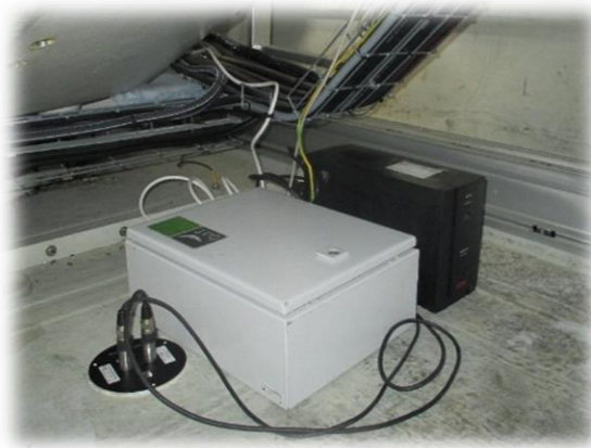
Éolienne E1 qui a été équipée avec un Batmode S+ (G. Marchais – Ecosphère)
