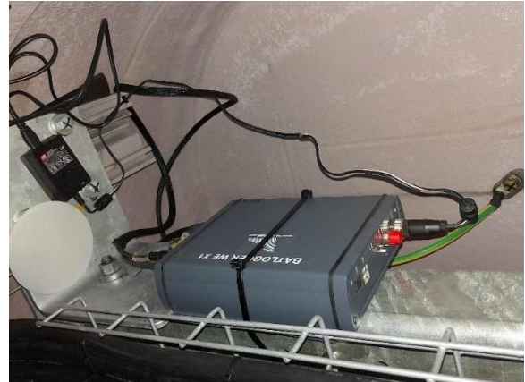
Batlogger installé dans la nacelle de l'éolienne E1 (à gauche) et E3 (à droite)
