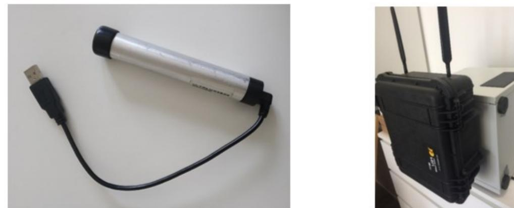
Figure 11 : Microphone mobilisé pour les études en altitude (à gauche) et boîtier TrackBat avec microphones déportés, installé en nacelle d'une éolienne (à droite)
