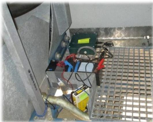
Photo 7 : Vue du dispositif installé : Anabat SD1 micro à l'envers posé sur une planche de bois et branché sur batterie 12 V
