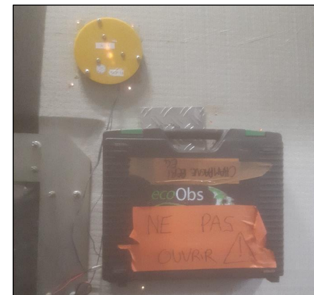
Figure 3 : Cliché de l'installation du Batcorder en nacelle avec micro à travers la paroi de la nacelle
