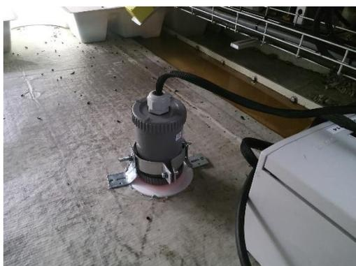
Figure 1 : Microphone positionné au sein de l'éolienne E6 en 2023
