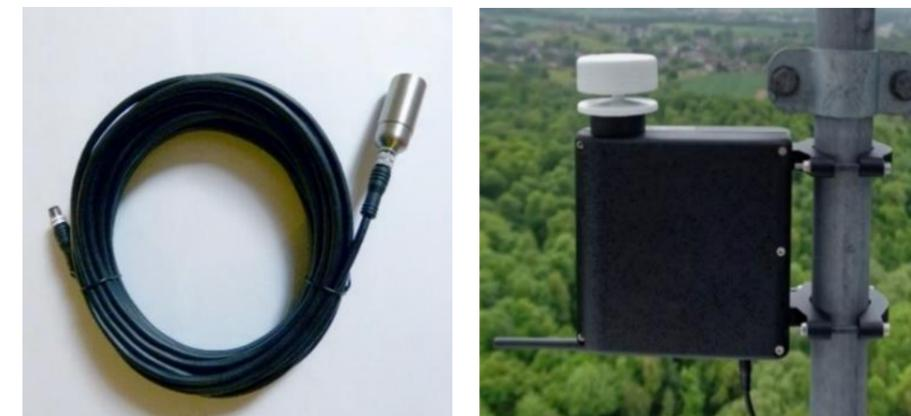
Figure 11 : Microphone mobilisé pour les études en altitude (à gauche) et boîtier TrackBat avec microphones intégrés, installé sur la nacelle d'une éolienne (à droite).
