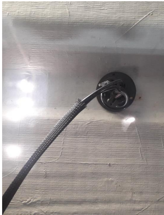
Figure 51. Installation du Batlogger au niveau de la nacelle de E2
