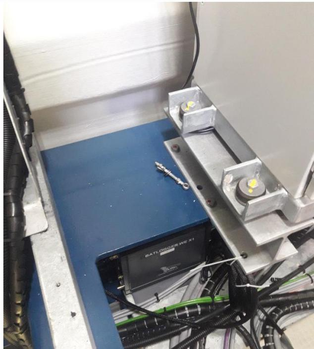
Le Batlogger WE X est branché sur une prise 220 V directement dans la nacelle de l'éolienne E2. Il transmet les données via un réseau GSM.
