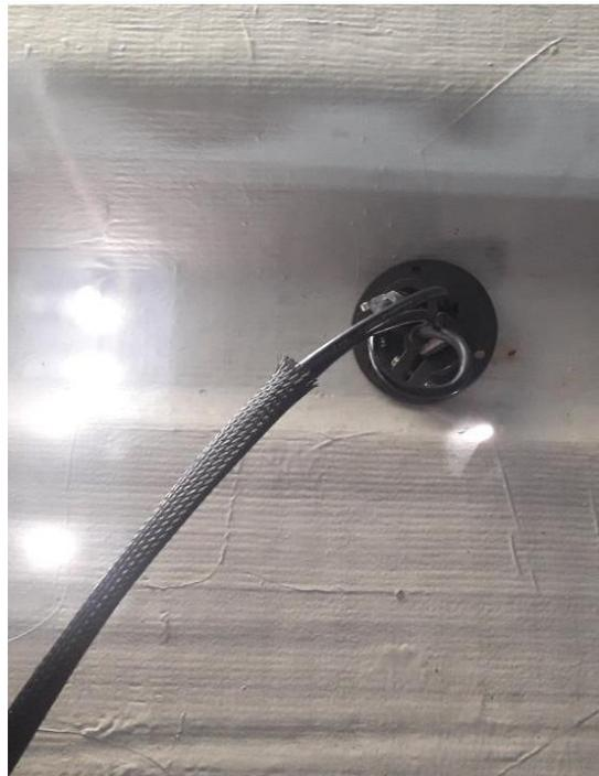
Le microphone est appliqué dans la fibre de la nacelle et orienté vers le bas.
