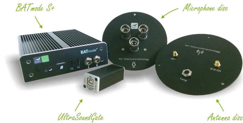
Figure 10 : Dispositif installé dans la nacelle d'éolienne (copyright : B.A.T.)
