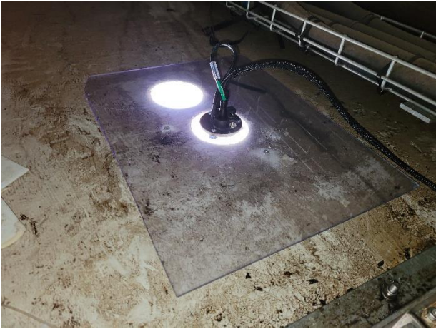
Photo 3. Localisation du microphone exploitant une ouverture déjà présente
