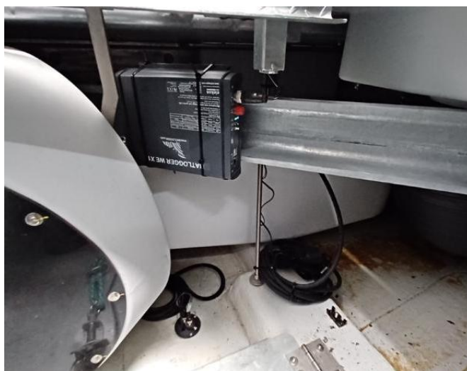
Batlogger installé dans la nacelle de l'éolienne E1. Source : ENGIE GREEN (Photographie prise sur site).
