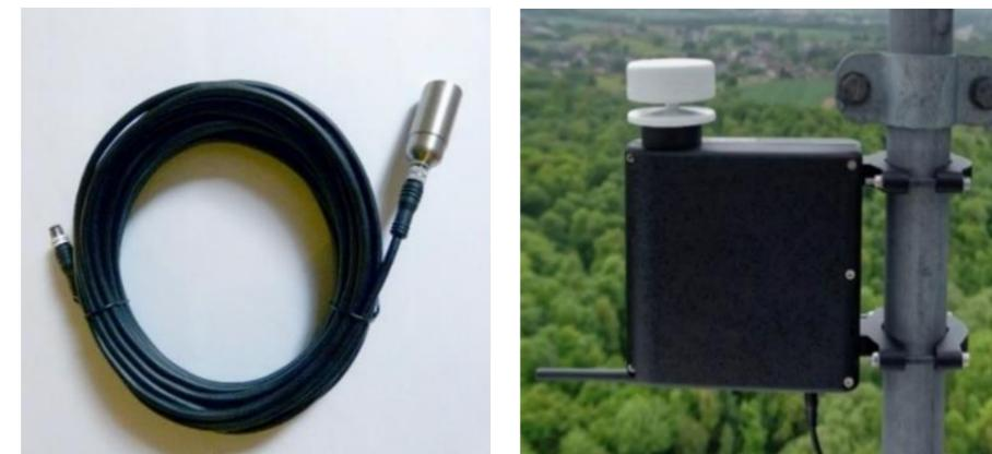
Figure 15 : Microphone mobilisé pour les études en altitude (à gauche) et boîtier TrackBat avec microphones intégrés, installé sur la nacelle d'une éolienne (à droite).
