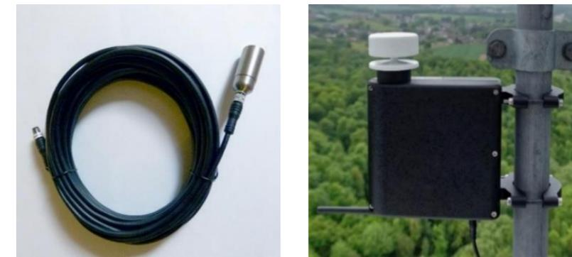
Figure 13 : Microphone mobilisé pour les études en altitude (à gauche) et boîtier TrackBat avec microphones intégrés, installé sur la nacelle d'une éolienne (à droite).
