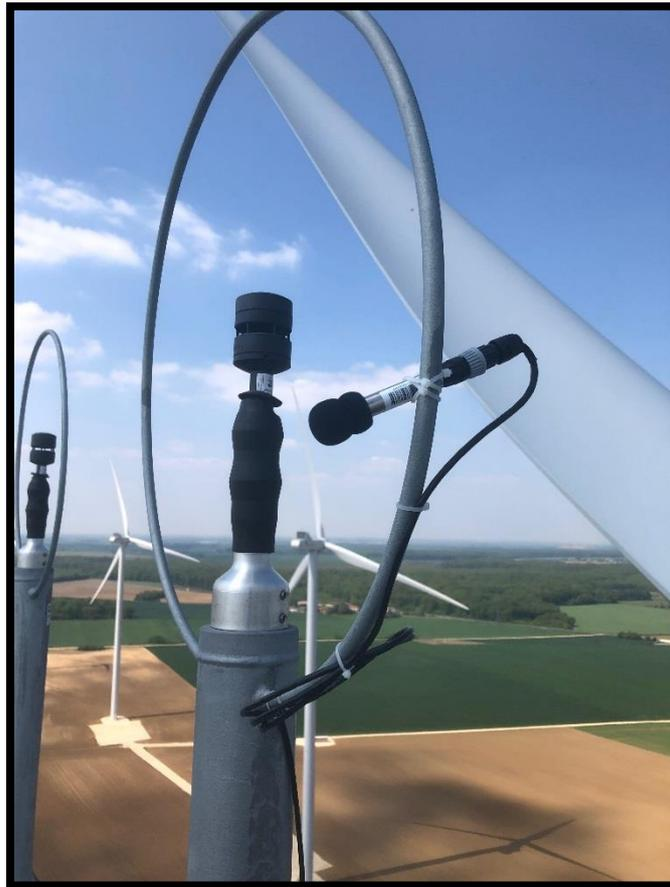
**Photo n° 1 : micro installé au sommet de l'éolienne.**
