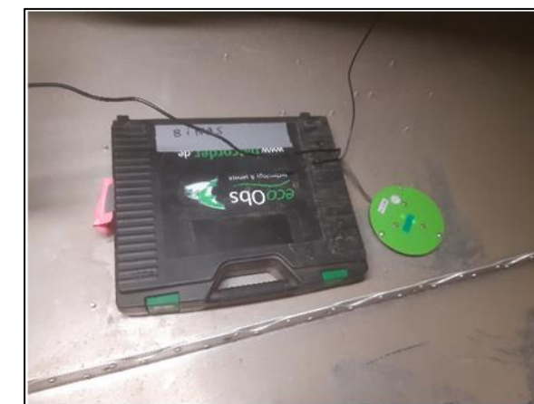
Figure 2 : Cliché de l'installation du Batcorder en nacelle E5 avec micro à travers la paroi de la nacelle
