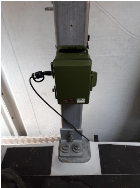
Figure 2 : Écoute en nacelle ; SM4 enregistrant du 23 mai au 11 aout 2018
