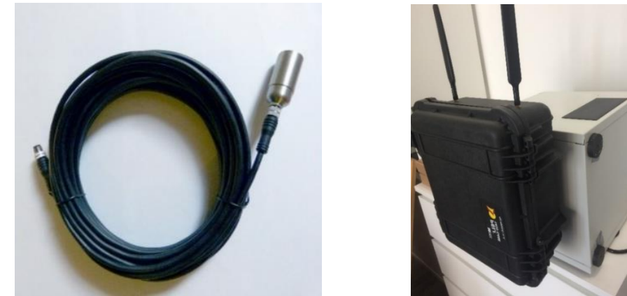
Figure 2 : Microphone mobilisé pour les études en altitude (à gauche) et boîtier TrackBat avec microphones déportés, installé en nacelle d'une éolienne (à droite).
