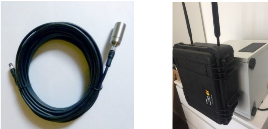
Figure 21 : Microphone mobilisé pour les études en altitude (à gauche) et boîtier TrackBat avec microphones déportés, installé en nacelle d’une éolienne (à droite).
