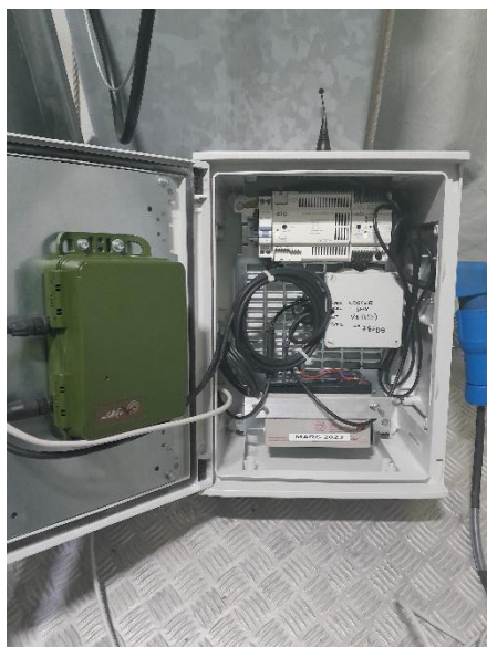
Figure 1 : Dispositif d'écoute en altitude installé en nacelle E03 du parc des Champarts en 2023.
