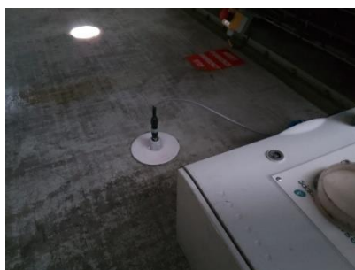
Figure 3 : Exemple de positionnement du microphone au sein d'une éolienne
