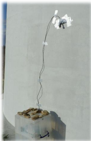
Photo 10 : SM2Bat+ installé au pied d'une éolienne
