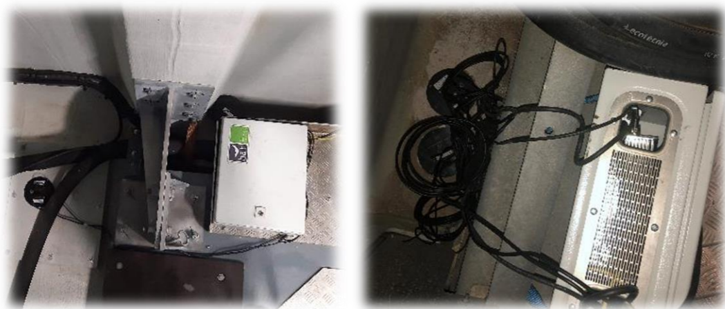
Batmodes S+ installés en nacelles des éoliennes LMD5 à gauche et LVL2 à droite (Écosphère)
