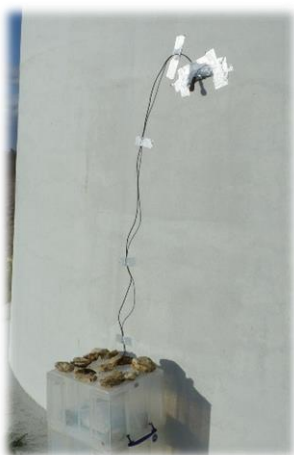
Photo 11 : SM2Bat+ installé au pied d'une éolienne
