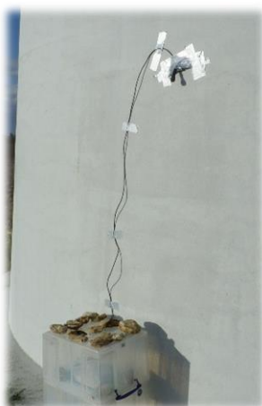
Photo 10 : SM2Bat+ installé au pied d'une éolienne
