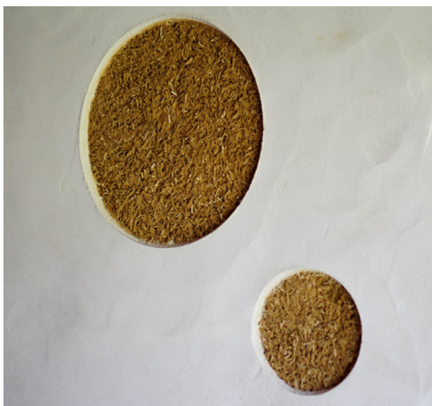
© Chanvriers en Circuits Courts – Enduit chanvre
