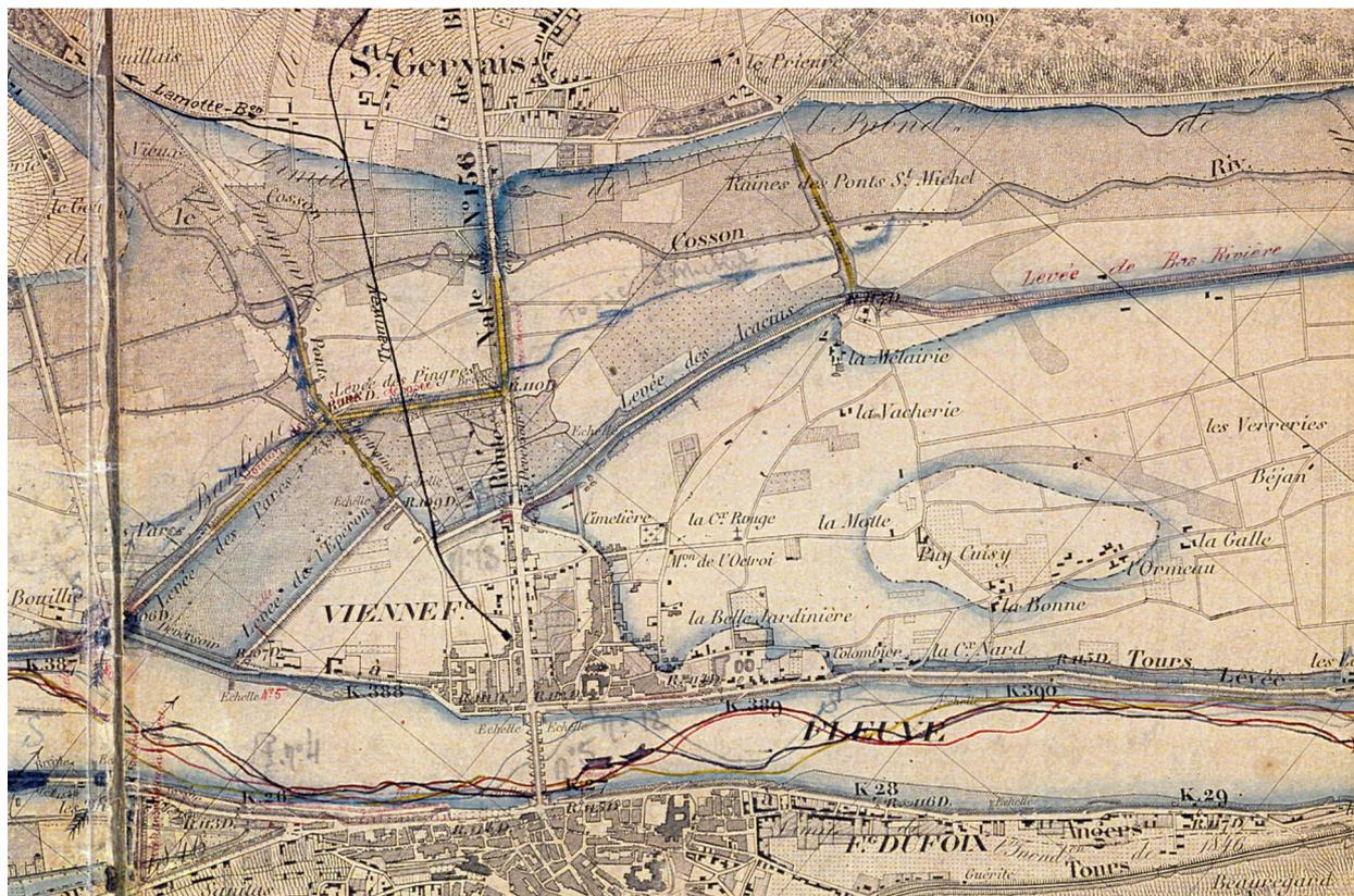
Carte représentant la crue de 1866 à Blois, réalisée en 1904 par le Service Spécial de la Loire des Ponts et Chaussées (en jaune, des ouvrages dégradés et détruits après 1866)
